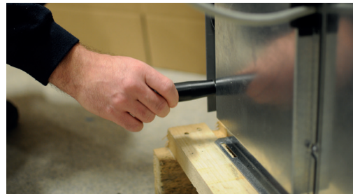
2. Fastgør de to bærehåndtag til bunden af kølemodul.
